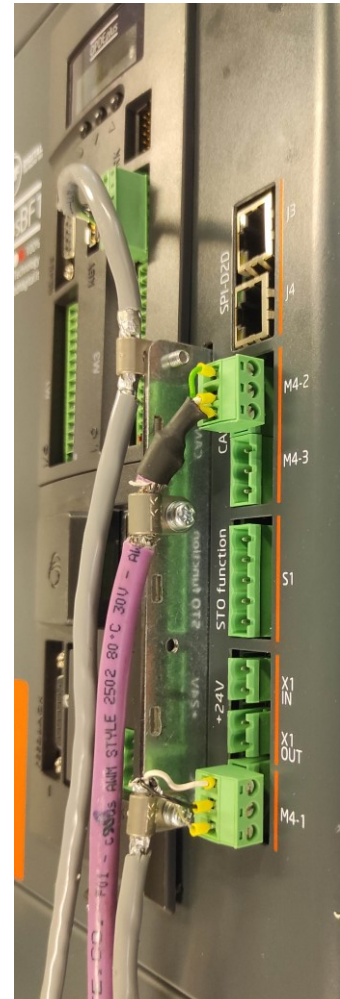
FIG. 37-Collegamento dei cavi schermati alla staffa / Shielded cable connection to the bracket
